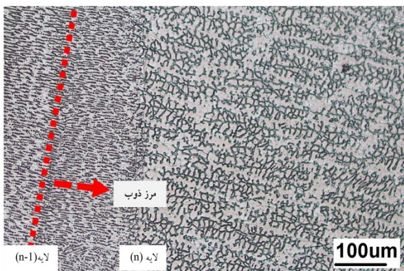
شکل 8- تصویر میکروسکپ نوری در امتداد مقطع عرضی در یک‌لایه، ریزساختار لایه‌ها و همچنین شاخصی را نشان می‌دهد که نشان می‌دهد حالت انجماد به تدریج از آستنیت ( \gamma ) اولیه و فریت ( \delta ) ثانویه (A/F) به فریت ( \delta ) اولیه و آستنیت ( \gamma ) ثانویه (F/A)، در یک‌لایه تغییر می‌کند
